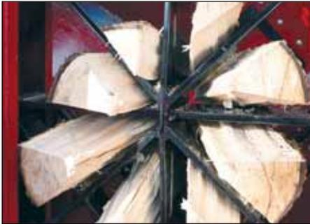
Жара 450 отлично подходит как для больших, так и для маленьких диаметров древесины. Цепная пила с гидроприводом легко и быстро кряжует стволы диаметром до 450 мм. Станок снабжён 24-тонным раскалывающим гидроцилиндром и автоматическим клапаном регулировки скорости, который всегда позволяет достичь оптимальной производительности при переработки древесины различного диаметра.
