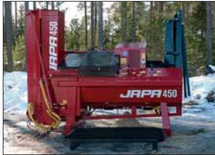
Жара 450 комплектуется 4-метровым выходным конвейером с гидравлическим приводом. Конвейер при помощи гидравлики может быть отклонён на 2 метра в обе стороны.
