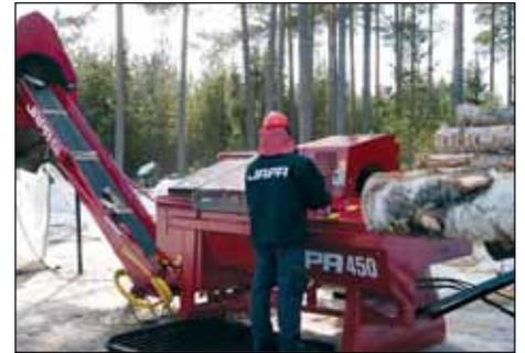
Управление машиной производится с помощью 6-ти гидравлических рычагов: подача, раскряжёвка, раскол, регулировка конвейера и т.д. Раскалывающее лезвие может быть заменено с помощью лебёдки.
