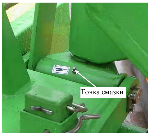
Рис. 26. Точка смазки вертикальной оси навесного устройства
