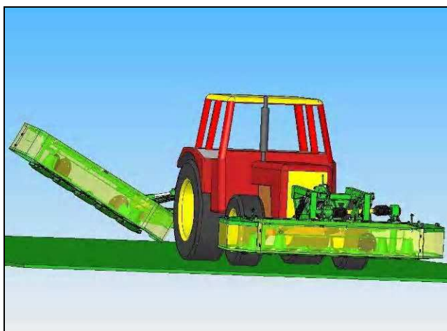
Рис.11а. Косилки KDF и KDT в положении для поворотов.
