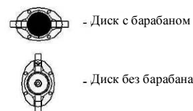
Рис. 14. Пользователь может самостоятельно регулировать ширину валка, заменяя диски без барабанов дисками с барабанами.
