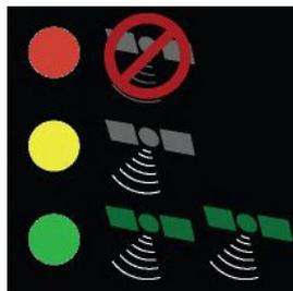
Сначала загорается **красный** индикатор состояния. Он указывает на отсутствие сигнала GPS достаточного качества. При этом возможно перемещение транспортного средства, а также управление системой OUTBACK S LITE для выполнения базовых настроек. При обнаружении достаточного количества спутников GPS загорается **желтый** индикатор состояния.
