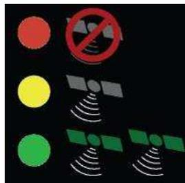
Сначала загорается **красный** индикатор состояния. Он указывает на отсутствие сигнала GPS достаточного качества. При этом возможно перемещение транспортного средства, а также управление системой GPS COPILOT для выполнения базовых настроек. При обнаружении достаточного количества спутников GPS загорается **желтый** индикатор состояния.
