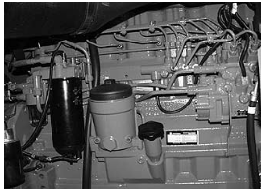
Диагностика двигателя, тип В - Двигатель 6081 с одинарными топливными фильтрами
