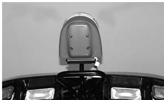
Приемник GPS STARFIRE с модулем приспособления к местности
