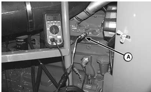
6068 Проверка на определение места повышения давления
