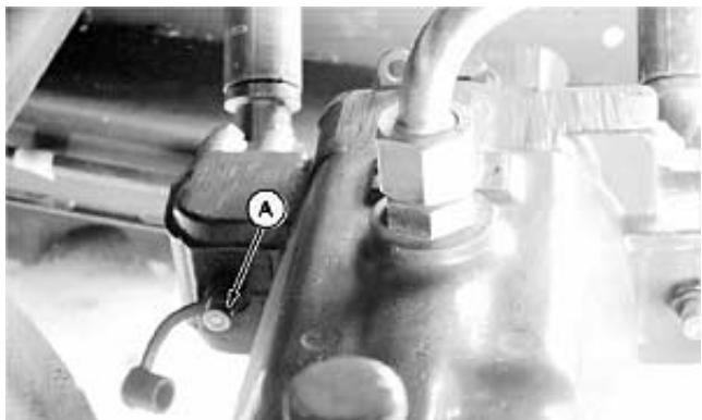
Гнездо диагностики высокого давления для переднего хода
