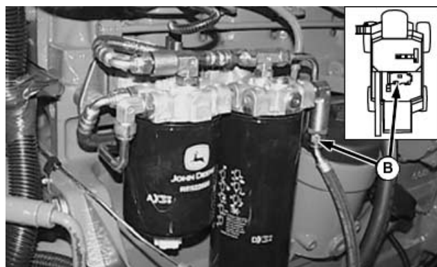
B - Впускной патрубок контрольного клапана топливного фильтра
