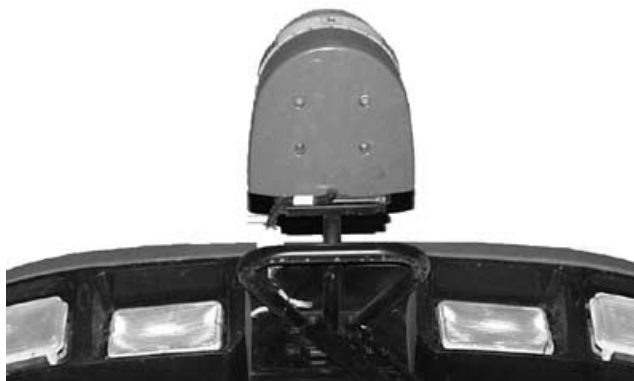
Приемник GPS STARFIRE без модуля приспособления к местности
