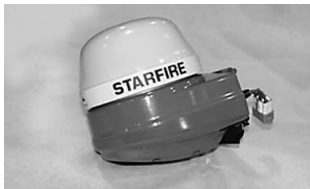
Приемник GPS STARFIRE с модулем приспособления к местности
