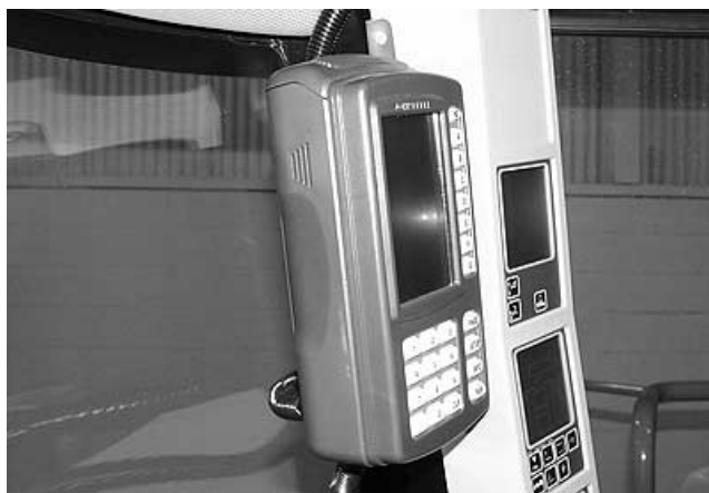
Дисплей GREENSTAR с мобильным процессором
