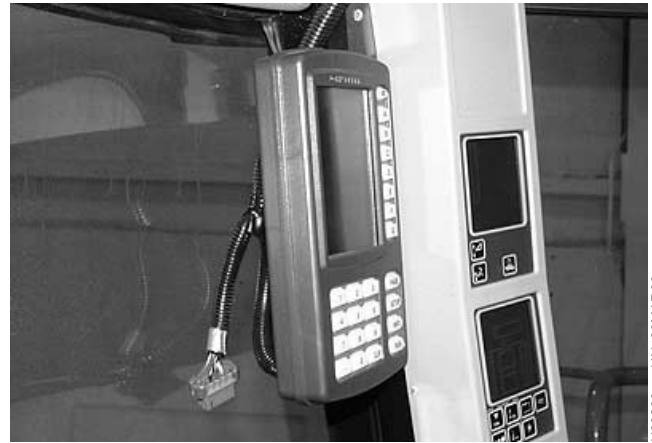
Дисплей GREENSTAR без мобильного процессора
