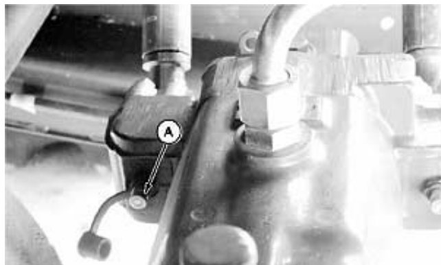
Гнездо диагностики высокого давления для переднего хода
