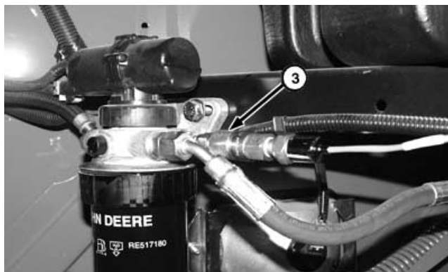
Отверстие 3 основания фильтра грубой очистки топлива
