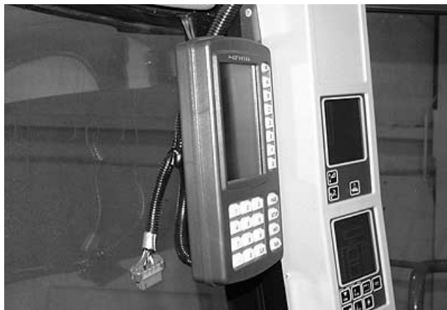
Дисплей GREENSTAR без мобильного процессора
