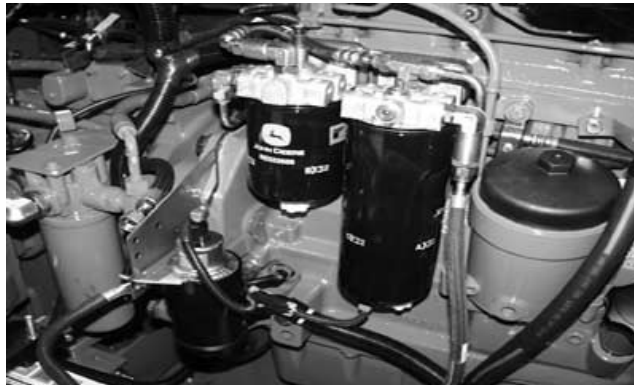
Диагностика двигателя, тип С - Двигатель 6081 со спаренными топливными фильтрами
