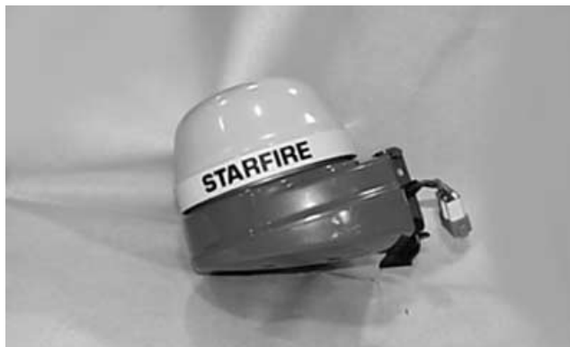
Приемник GPS STARFIRE без модуля приспособления к местности
