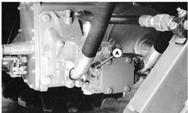
Клапан сброса высокого давления для хода вперед
