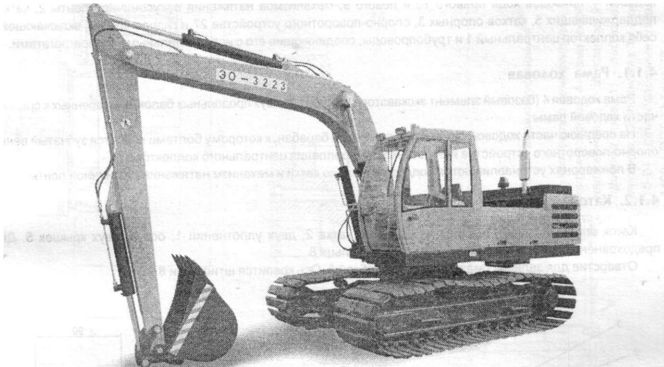
Рис. 1. Общий вид экскаватора с рабочим оборудованием.
