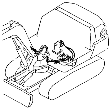
Fig.68 油圧配管(バルブ ~ モータ, ブーム) HYD. OIL PIPING (VALVE ~ MOTOR, BOOM)
