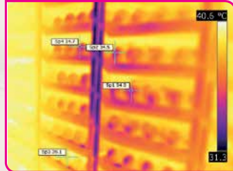
Термическое изображение яиц, охлаждаемых неисправными соплами увлажнителя воздуха
