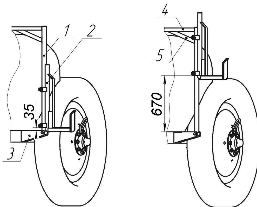
Рис. 18. Схема изменения расположения транспортной опоры штанги.
