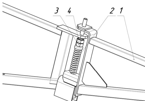
Рис. 12. Элементы регулировки предохранительного устройства крайней секции.
