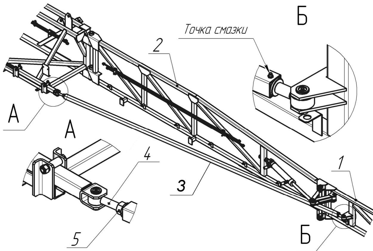
Рис. 13. Элементы регулировки реактивной тяги.
