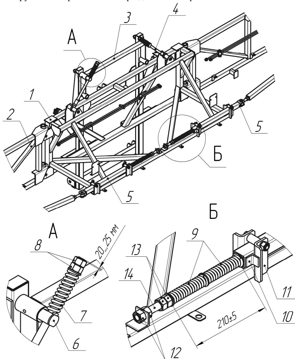
Рис. 14. Элементы регулировки длины растяжек подвески (А) и компенсатора (Б).
