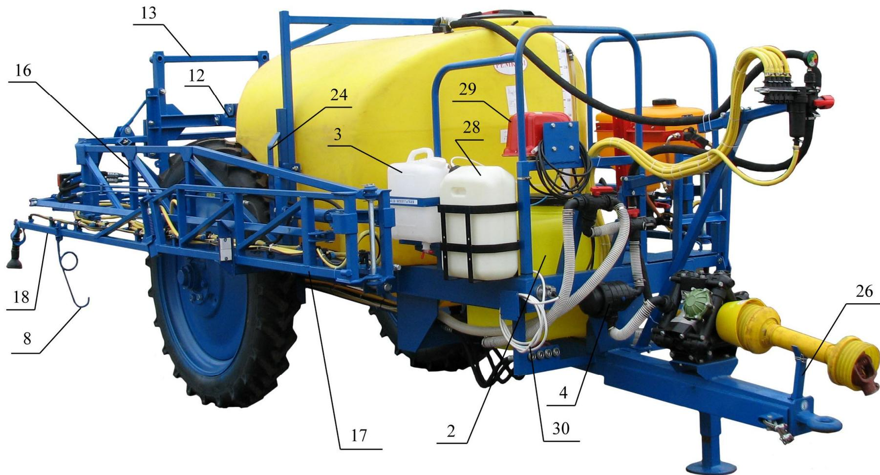
Рис. 16. Опрыскиватель ОП-2500-18. Общий вид (подрисуночные подписи см. на рис. 1а).
