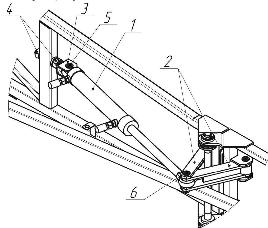
Рис. 15. Элементы регулировки гидроцилиндра складывания штанги.
