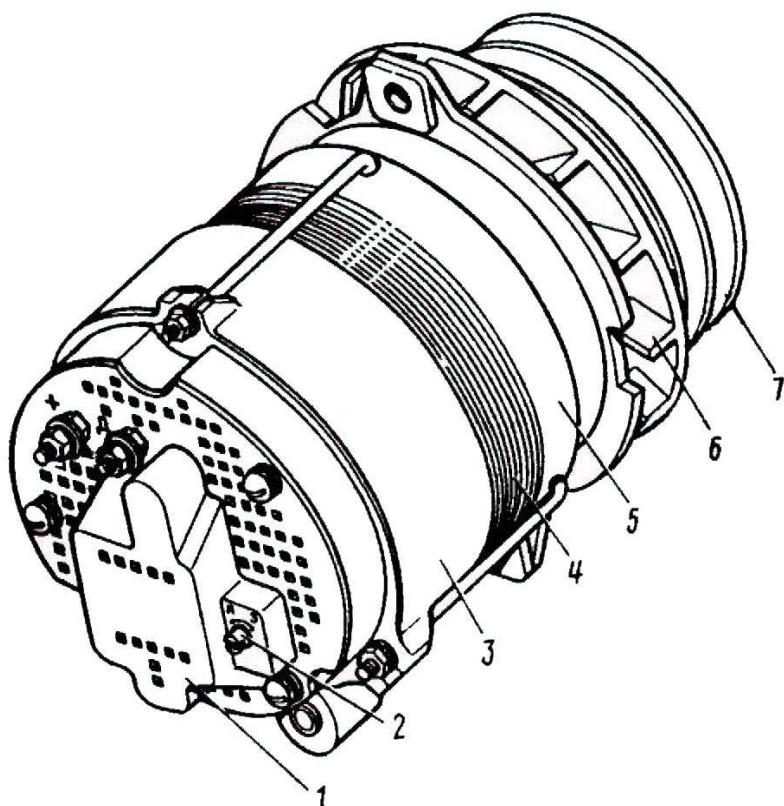
1 – крышка регулирующего устройства; 2\* – винт переключателя посезонной регулировки напряжения "Зима-Лето"; 3 – крышка задняя; 4 – статор; 5 – крышка передняя; 6 – вентилятор; 7 – шкив.
