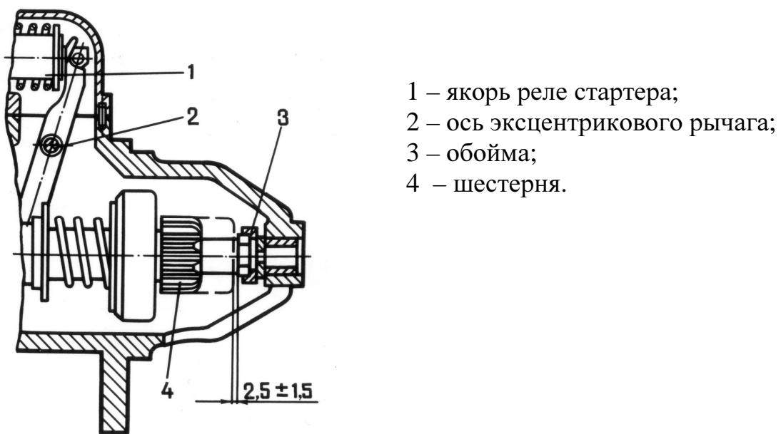
Рисунок 22 – Схема регулировки включения стартера
