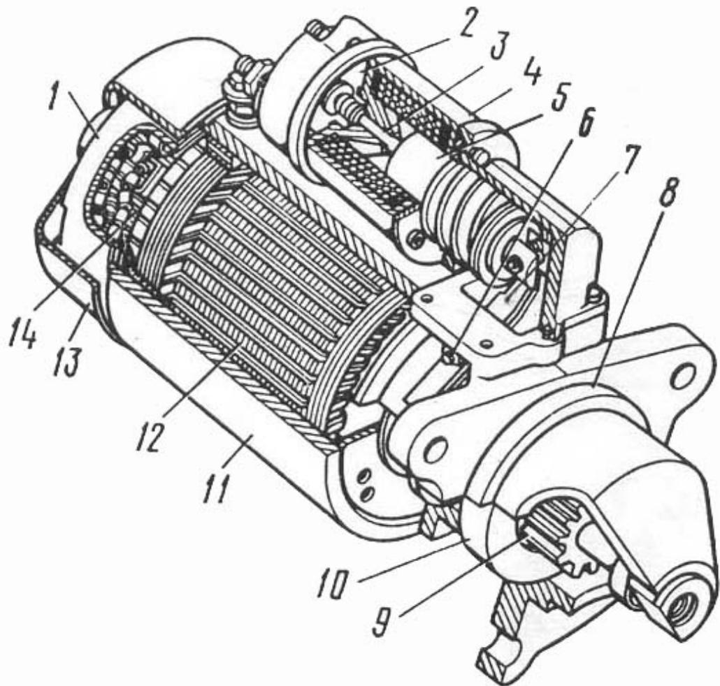
1 – крышка со стороны коллектора; 2 – диск контактный; 3 – шток;
