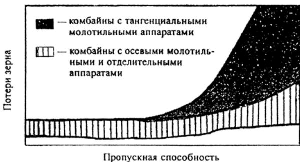
Рис. 288 Взаимосвязь между пропускной способностью и потерями зерна у комбайнов с тангенциальными и осевыми молотильными аппаратами (833)
