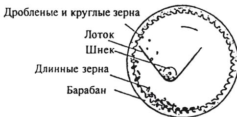
Рис. 333 Принцип действия триера (428)
