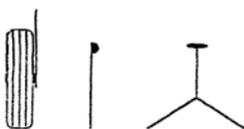
Рис. 152      **Покрывающие рабочие органы зерновых сеялок [648]**
