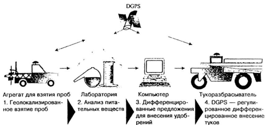
Рис. 270 Схема внесения минеральных удобрений по системе DPGS (765)
