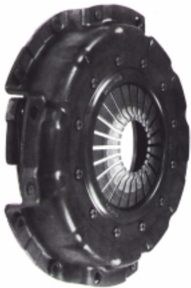
Рис. 5.4. ФС с прямой установкой разрезной тарельчатой пружины: а - внешний вид; б - конструкция; 1 - разрезная тарельчатая пружина; 2 - нажимной диск; 3 - кожух ФС; 4 - выжимной подшипник; 5 - маховик двигателя; 6 - тангенциальная пластина; 7 - ведомый фрикционный диск
