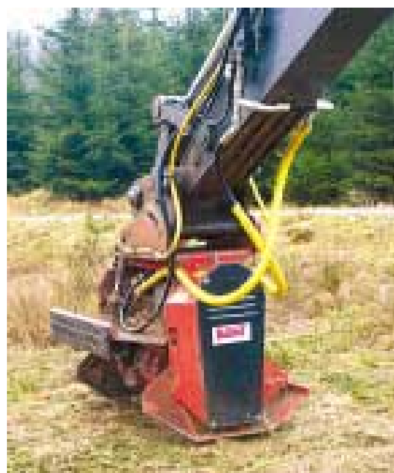
Рисунок 125 – Корчевание пней специальным приспособлением (Франция)
