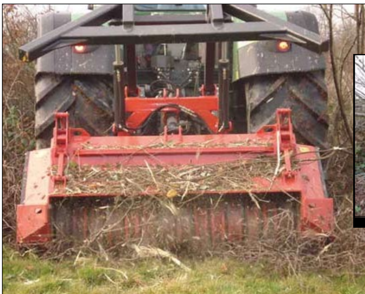
Рисунок 124 – Прицепное роторное оборудование для дробления камней, кустарников, деревьев (Франция)
