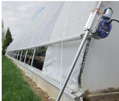
РИС. 1. СВОРАЧИВАЮЩИЕСЯ БОКОВЫЕ ШТОРЫ, ОСНАЩЕННЫЕ МОТОРОМ
