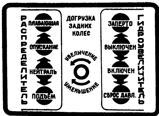
Рис. 8. Схема управления гидросистемой трактора.
