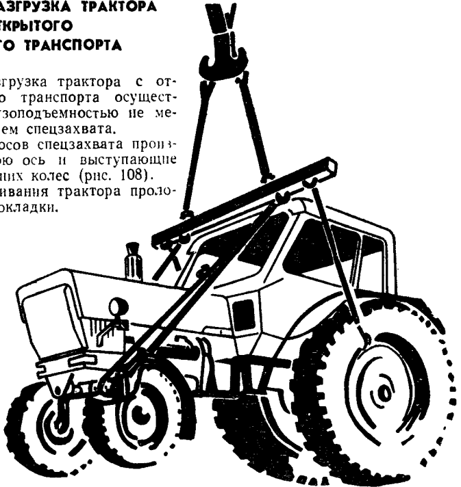
Рис. 108. Схема захвата трактора тросами.
