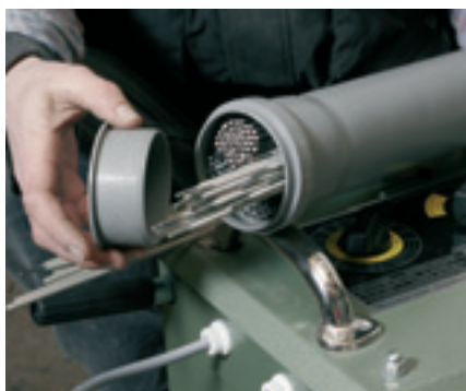
Емкость для электродов, сделанная своими силами из водосточной трубы.
