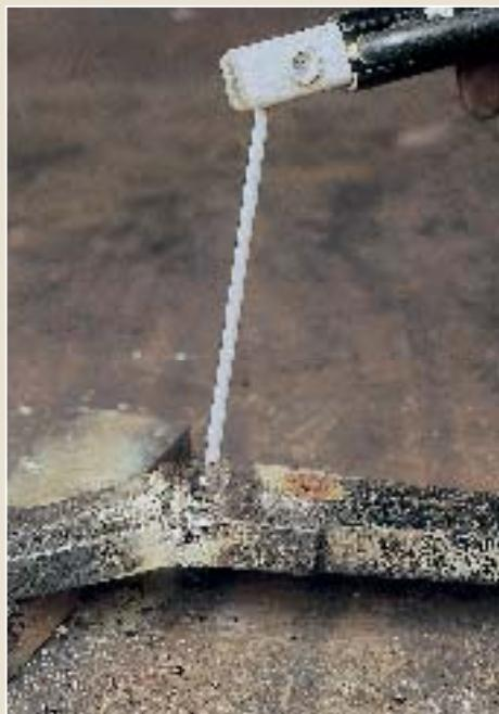
Чтобы сохранить первоначальную форму, обе части рычага сначала точно прикладываются друг к другу, а затем привариваются с одной стороны без подготовки шва ...
