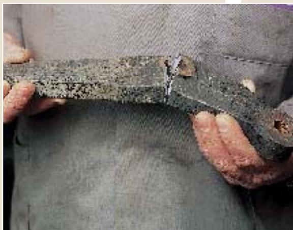
Рычаг сломался точно по просверленному отверстию. Важно, чтобы после сварки его первоначальная форма была в точности восстановлена.
