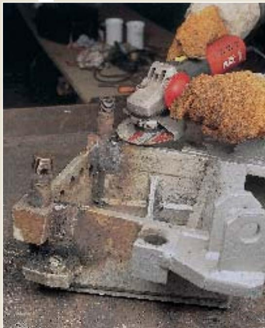
Затем сварные швы зашлифовываются под углом шлифовальной машиной. Слишком выпуклые сварные швы, скорее всего, будут нарушать расположение силовых линий.
