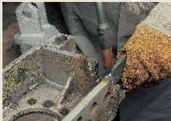
Чтобы заполнить зазор, приваривается плоская металлическая пластина необходимой толщины. Для лучшей фиксации обрезать ее можно после приваривания.
