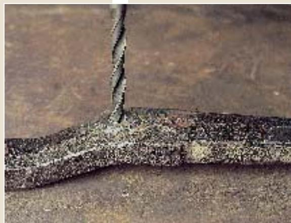
ленное отверстие. В конечном итоге отверстие полностью заваривается. При использовании высоколегированных электродов (это именно тот случай) это не составит особой проблемы, так как шлак имеет хорошее свойство: находится всегда на поверхности сварочной ванны. В противном случае образовывались бы значительные вкрапления шлака в
