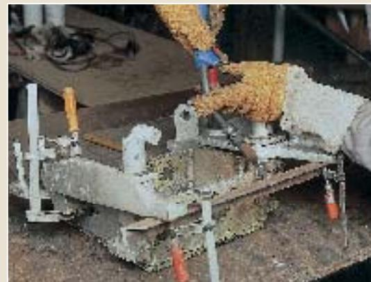
Чтобы убедиться в том, что все исправно функционирует, перед тем, как прихватить деталь сваркой, мы предусмотрительно собрали весь механизм. Для точной установки дополнительно применялись железные уголки и струбцины.
