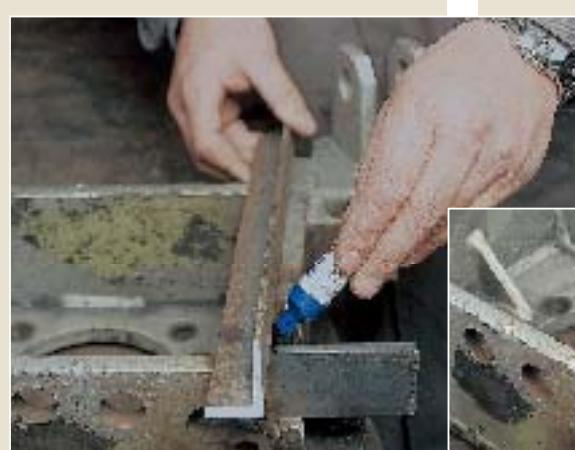
Прежде, чем решитесь отрезать пластину, точно отмерьте необходимую длину. Используйте для этого металлический уголок, на котором можно точно отметить место среза. Оставьте при этом запас для сварного шва.
