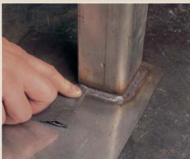
Чтобы предотвратить последующее окисление, необходимо отшлифовать до блеска плоскости со следами побежалости.
