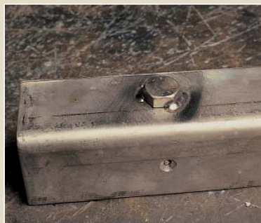
Под приваренной всего двумя точками головкой болта может образоваться ржавчина.
