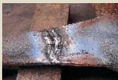
С каждой стороны разрыва и параллельно ему на деталь навариваются дополнительные швы.
