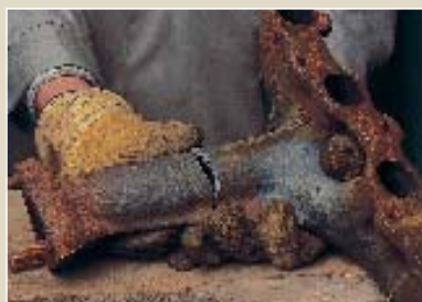
При работе с электродами для сварки чугуна нет необходимости в шлифовке основы.
