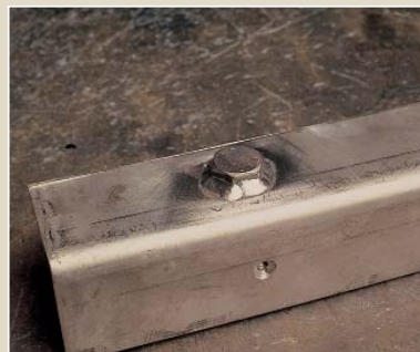
У ржавчины нет шансов, если головка болта будет плотно приварена к основе.
