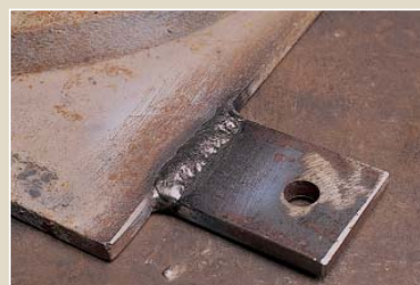
Затем стальная часть приваривается к подготовленной чугунной основе электродом для сварки чугуна.
