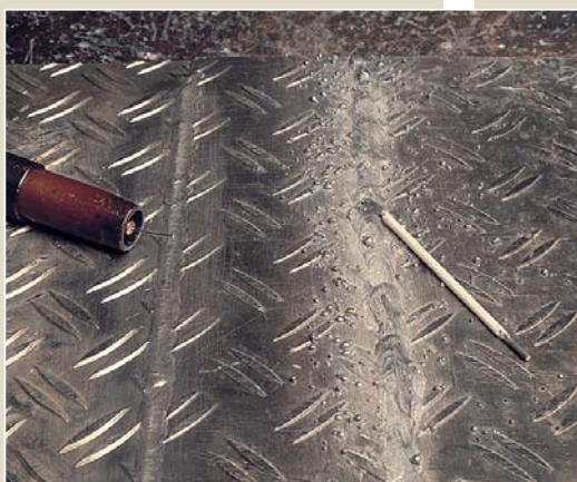
На данном примере хорошо заметна разница в качестве работы газосварки (слева) и при сварке стержневым электродом (справа).
