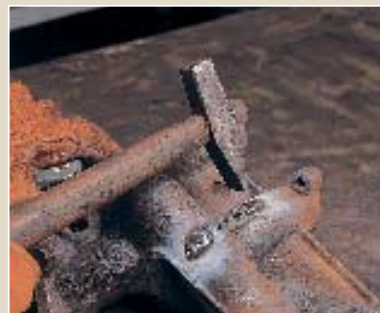
После каждого этапа наложения шва свежий шов необходимо проковать и тем самым растянуть.
