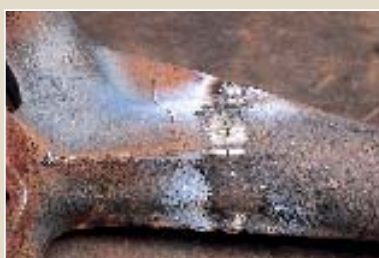
После этого компоненты сплошным швом свариваются друг с другом.
