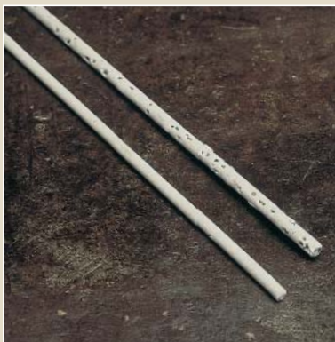
На оболочке электрода появились небольшие отверстия, что вызвано их хранением на воздухе.
