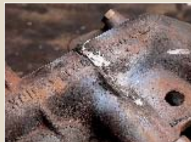
Чтобы устранить поры, первый шов необходимо шлифовать и повторить процедуру сварки.
