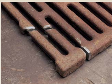
Ширина шва между обломками должна приблизительно соответствовать толщине электрода.
