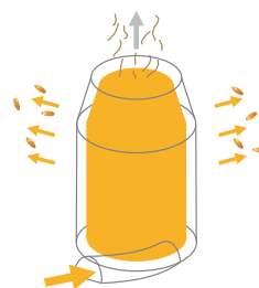
Рис. 25. Объемное взаимодействие массы и обмолачивающих элементов
