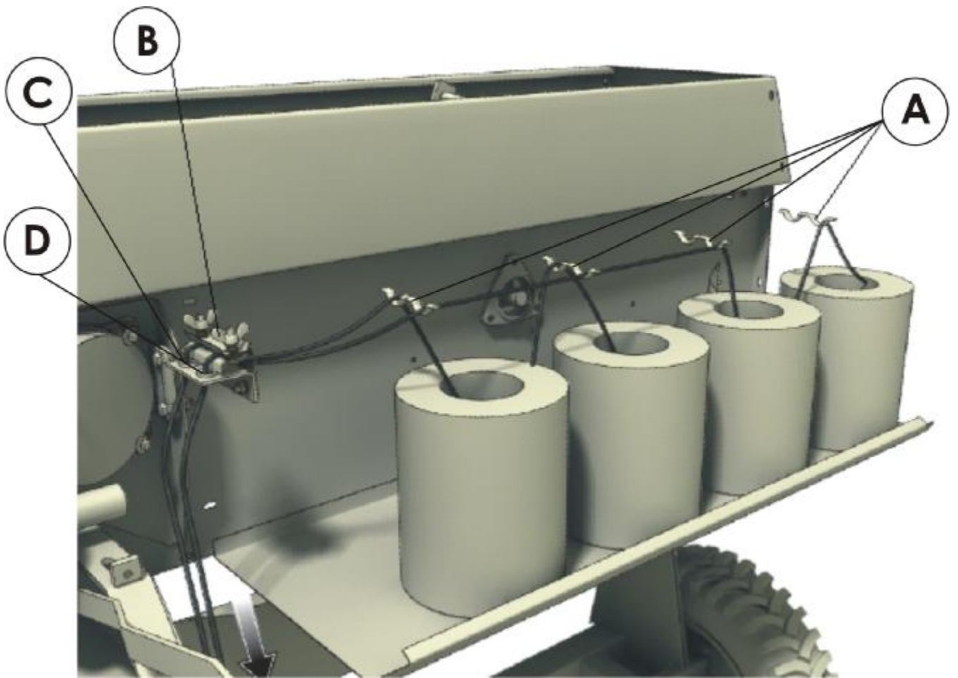
Рисунок 39 Установка бухт шпегата
